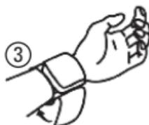
**Note :** Dans son conditionnement, le bracelet de l'autotensiomètre est fixé au moniteur. Si le bracelet se détache du moniteur, alignez les 2 embouts et les 4 crochets du bracelet avec les 2 cavités et les 4 encoches situées sur la face arrière du moniteur et appuyez le bracelet contre le moniteur jusqu'à ce que les embouts et les crochets soient fixés.
