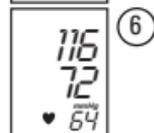
Après la 91<sup>ème</sup> mesure, les résultats seront automatiquement enregistrés et l'appareil effacera automatiquement la mémoire n°1.
